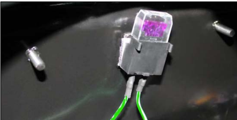
Zusatzsicherungsträger für das D + Signal (Abb. beispielhaft)
