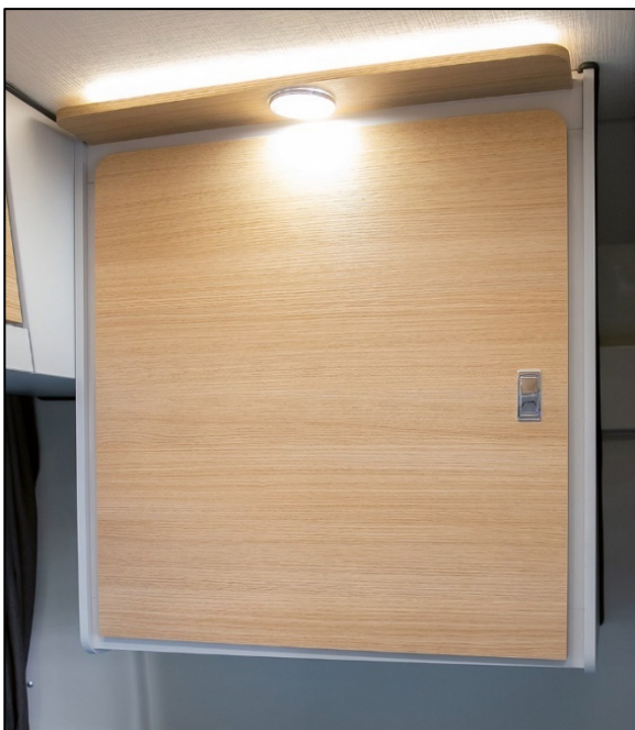
Einbauleuchte rund und Indirektlichtband
