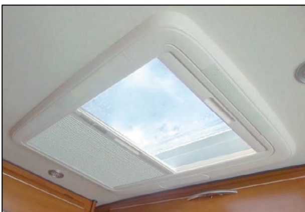
Verdunkelungsrollo der Dachhaube
