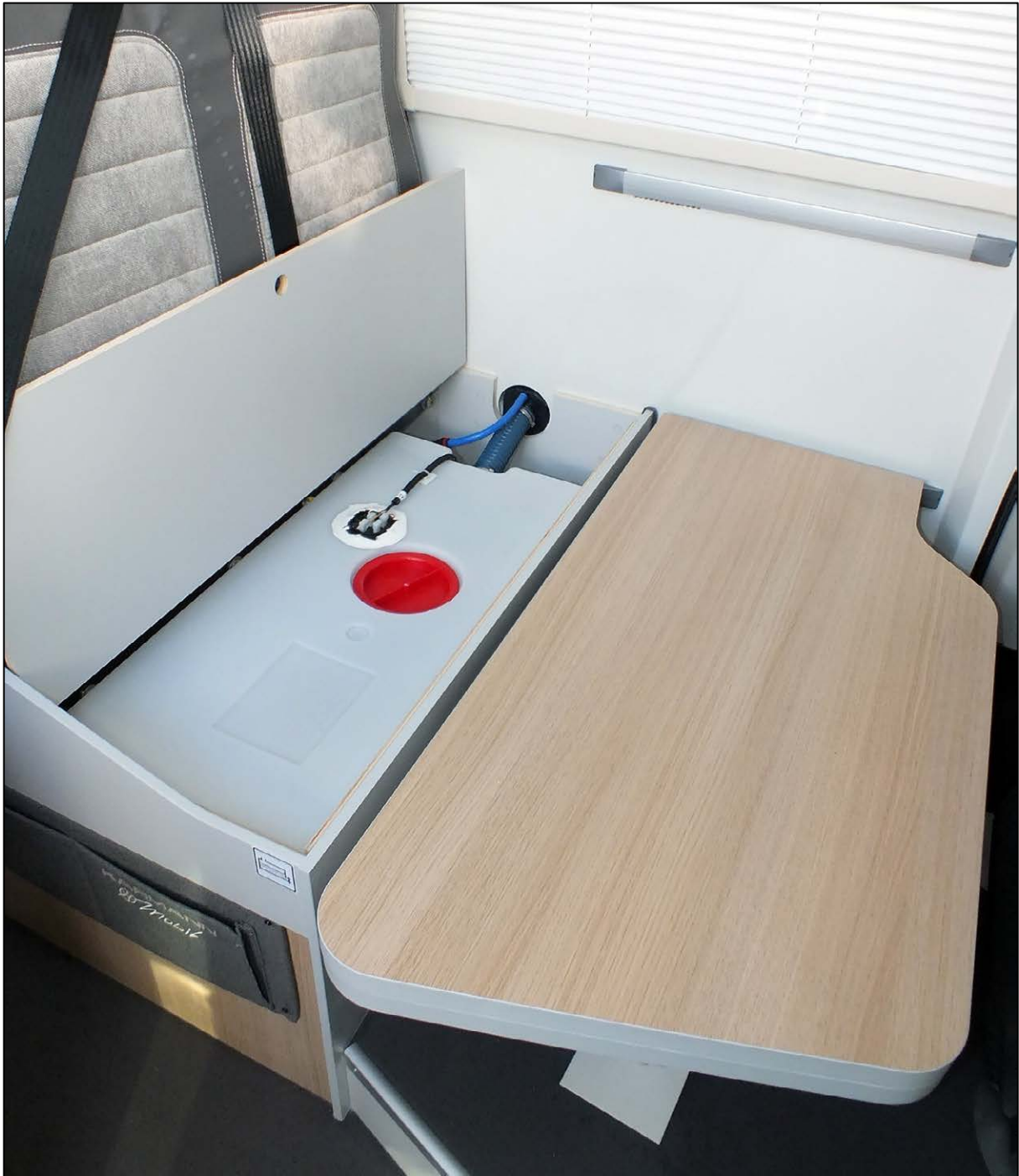
Frischwassertank im Sitzkasten der Sitzbank (Abb. beispielhaft)
