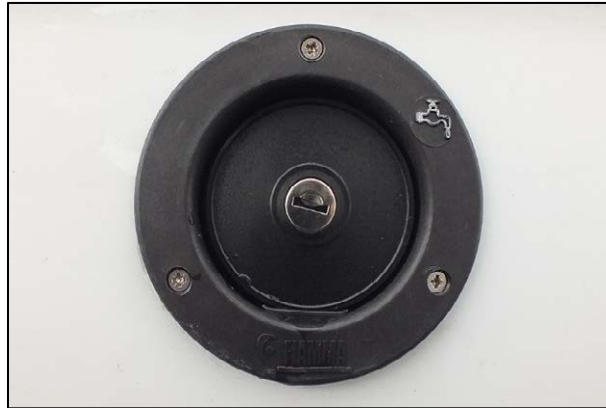
Einfüllöffnung Frischwasser (Abb. beispielhaft)
