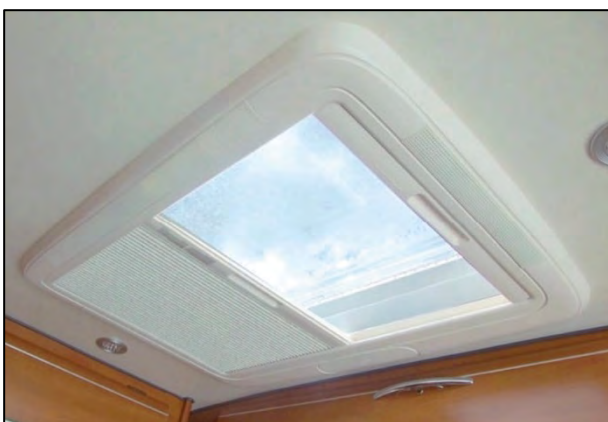
Verdunkelungsrollo der Dachhaube
