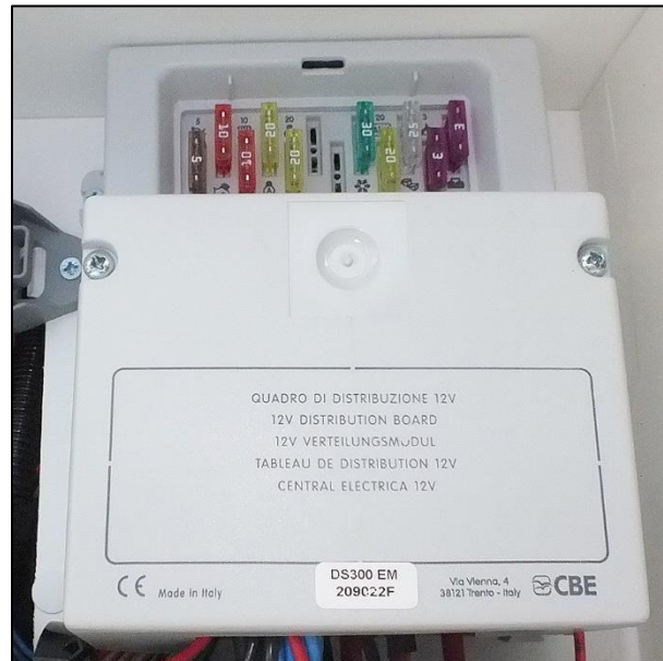
12 V-Sicherungskasten mit Verteilerfunktion (Abb. beispielhaft)
