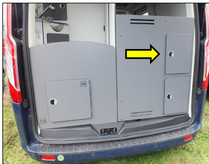
Zugang Frischwasser-Pumpe (Pfeil) beim Duncan 545 (Abb. beispielhaft)
