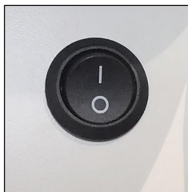
Ein- und Aus-Schalter für das Ambientelicht (Abb. beispielhaft)
