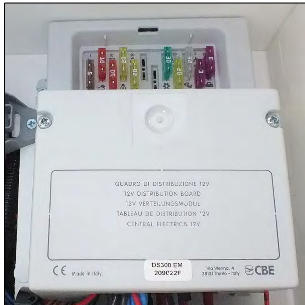
Scatola dei fusibili 12 V con funzione distributrice (fig. di esempio)
