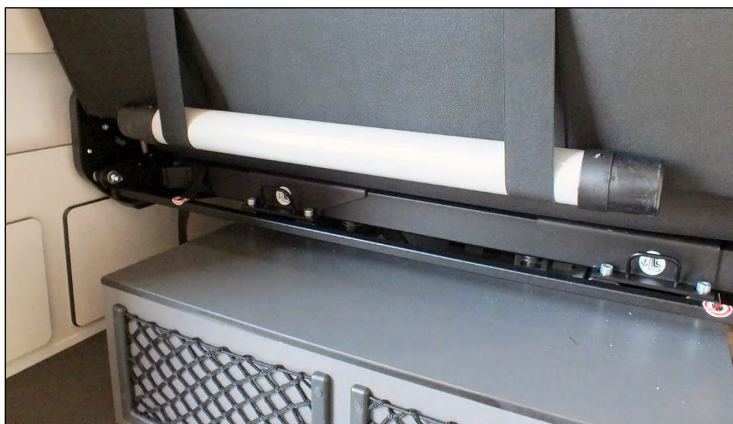
Gamba del tavolo stivata dietro la panca posteriore (fig. di esempio)
