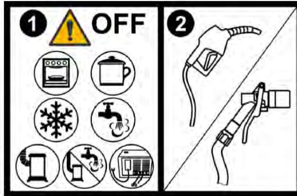
Autocollant « Fermer les vannes d'arrêt de gaz avant de faire le plein » (exemple)
