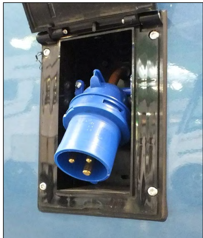
CEE-Einspeise-Stecker (230 V) an der Fahrzeugaußenseite (Abb. beispielhaft)
