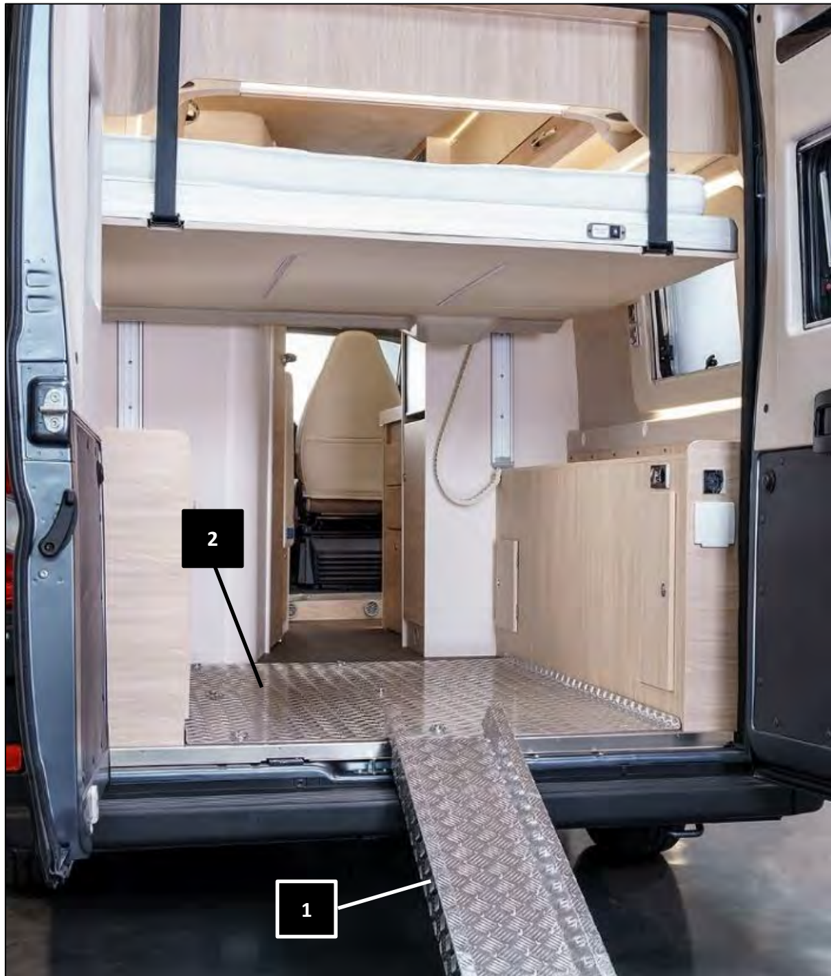
Auffahrrampe und Blechwanne beim Davis 630 (Abb. beispielhaft)
