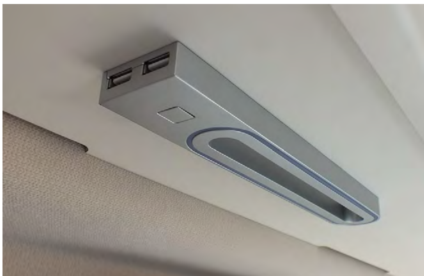
Lampe de lecture à LED de type II avec 2 prises USB sur le côté (exemple)
