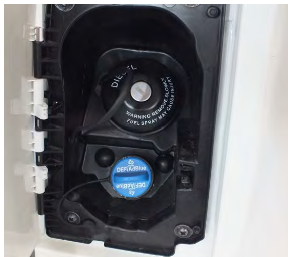
Bouchon de remplissage pour AdBlue à côté de la porte conducteur (exemple)
