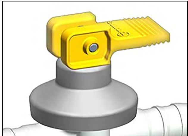
gelbes Klappventil zur Entleerung des Boilers (Stellung „geschlossen“)
