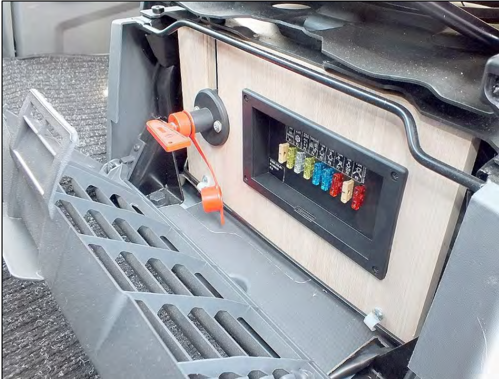
Boîte à fusibles 12 V avec fonction de distribution et interrupteur coupe-batterie (exemple)
