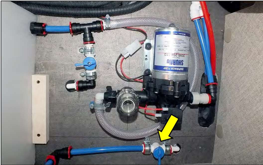
Ablassventil „Inhalt Frischwassertank auf 20 L reduzieren“ beim DA 591 (Abb. beispielhaft)
