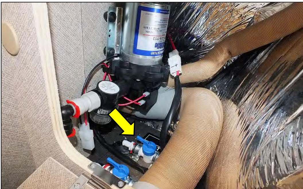
Ablassventil „Inhalt Frischwassertank auf 20 L reduzieren“ beim DA 590/591 mit 137 L Kühlschranks (Abb. beispielhaft)
