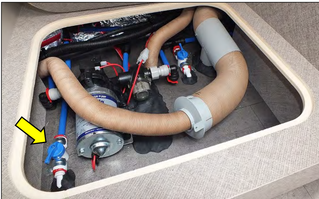
Abllassventil „Inhalt Frischwassertank auf 20 L reduzieren“ beim DA 590 (Abb. beispielhaft)
