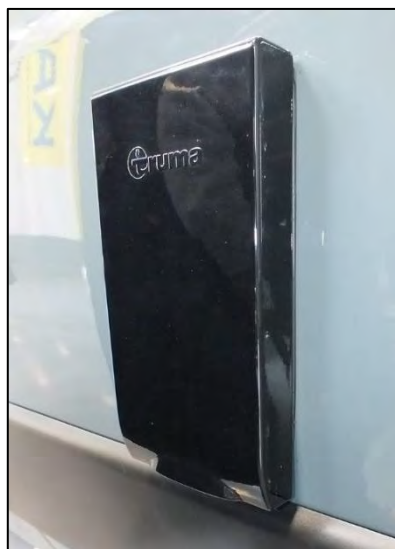
Évacuation/arrivée d'air du chauffe-eau à l'extérieur du véhicule sur le Davis avec équipement TS (exemple)
