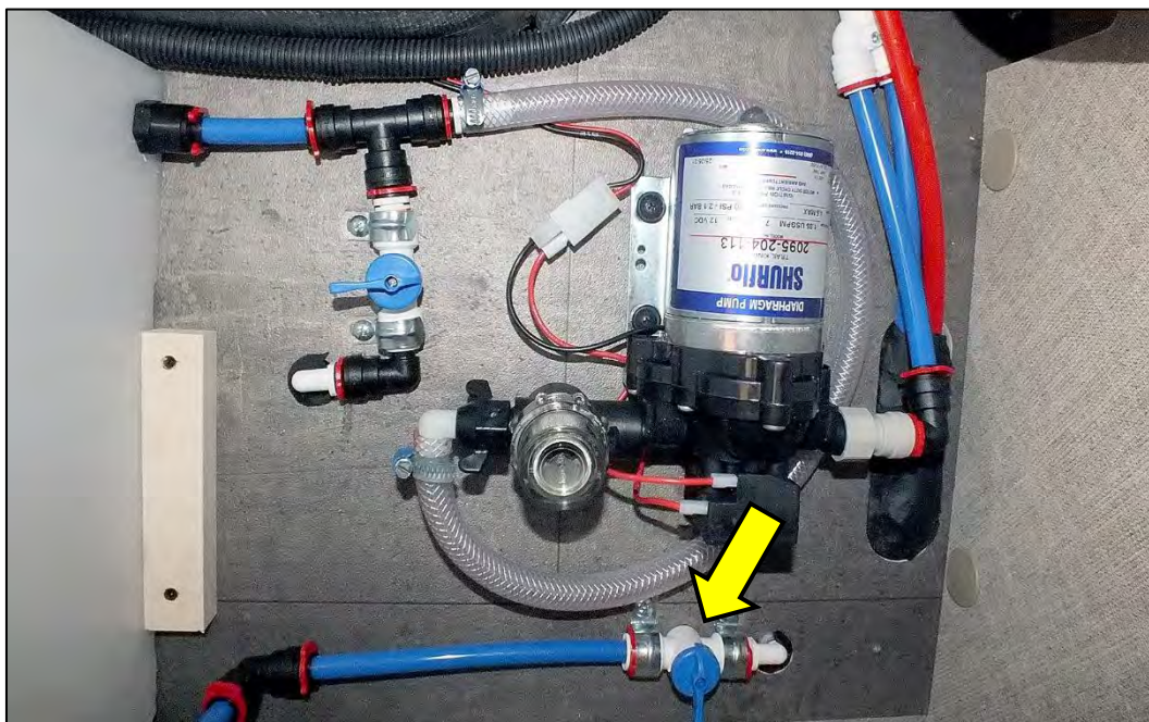
Souape de vidange « Réduire le contenu du réservoir d'eau propre à 20 L » sur le DA 591 (exemple)
