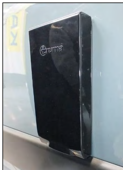
Abluft/Zuluft-Element des Boilers an der Fahrzeugaußenseite beim Davis mit TS-Ausstattung (Abb. beispielhaft)
