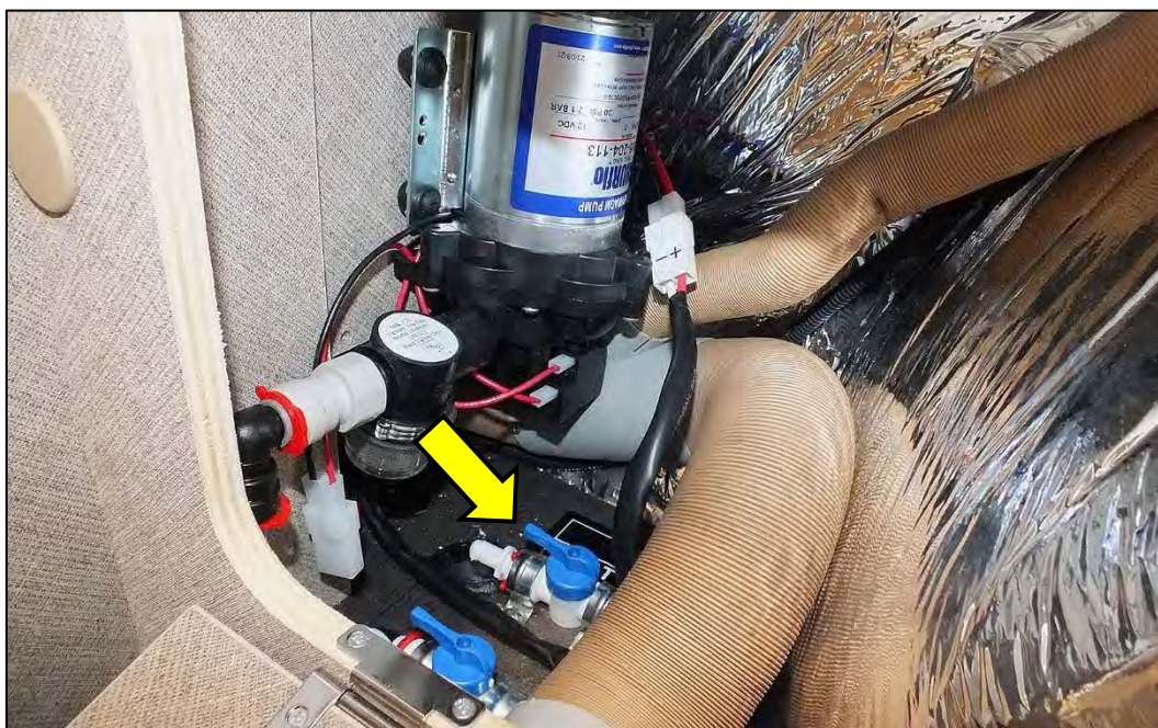
Souape de vidange « Réduire le contenu du réservoir d'eau propre à 20 L » sur le DA 590/591 avec réfrigérateur de 137 L (exemple)
