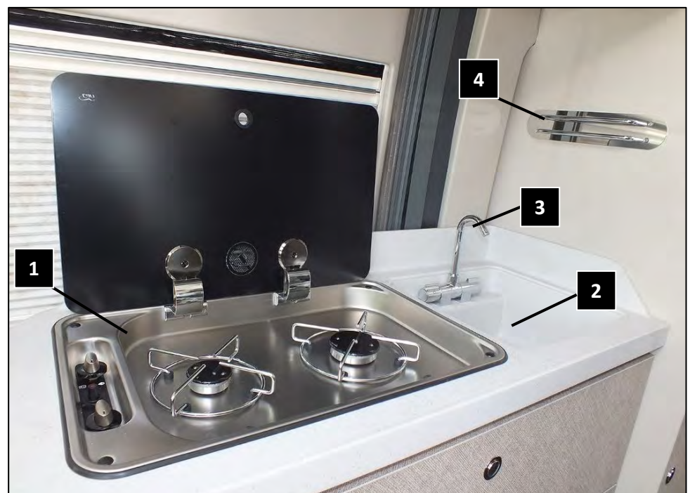
Gaskochstelle mit Spüle beim DA 620 LS (Abb. beispielhaft)
