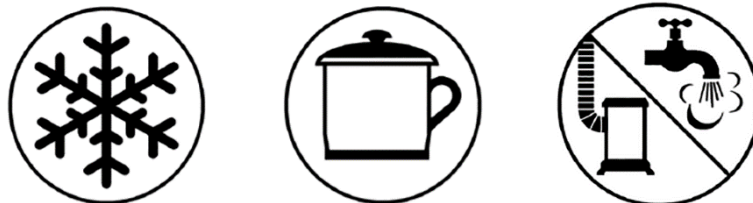
Pictogrammes des vannes d'arrêt de gaz, de gauche à droite : réfrigérateur, réchaud, chauffe-eau
