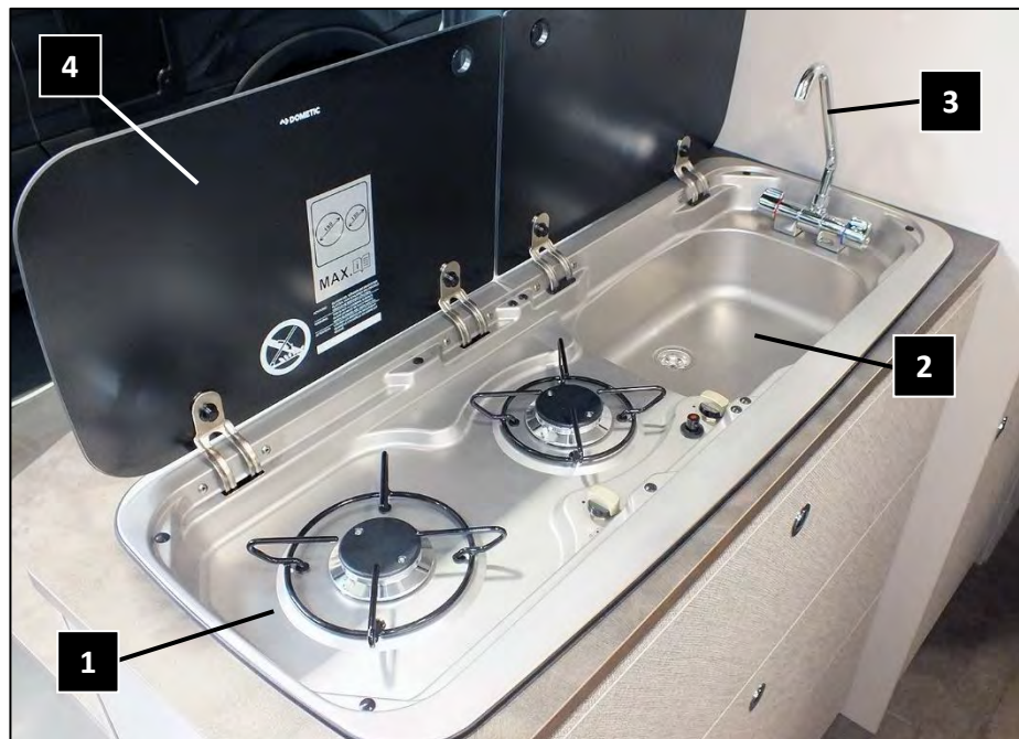
Gaskochstelle mit Spüle beim DA 620 TS (Abb. beispielhaft)
