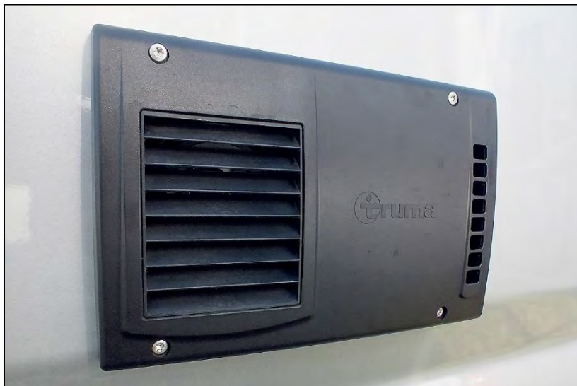
Abluft/Zuluft-Element an der Fahrzeugaußenseite bei Davis LS-Fahrzeugen (Abb. beispielhaft)
