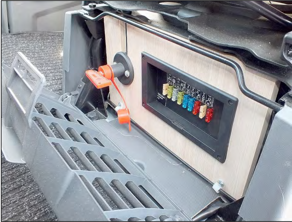
12 V-Sicherungskasten mit Verteilerfunktion und Batterietrennschalter (Abb. beispielhaft)
