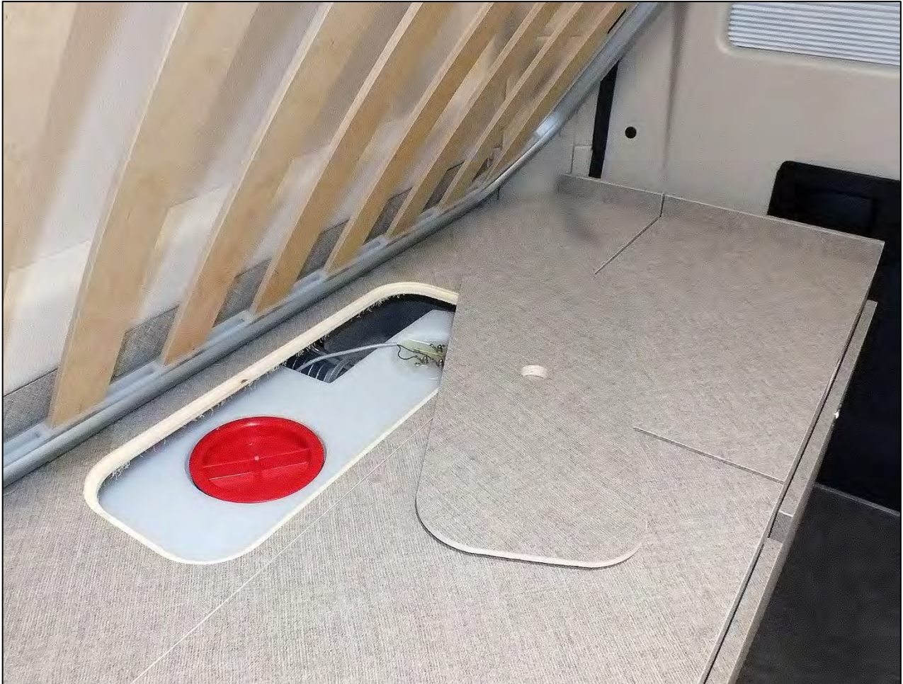
Accès au réservoir d'eau propre (exemple)
