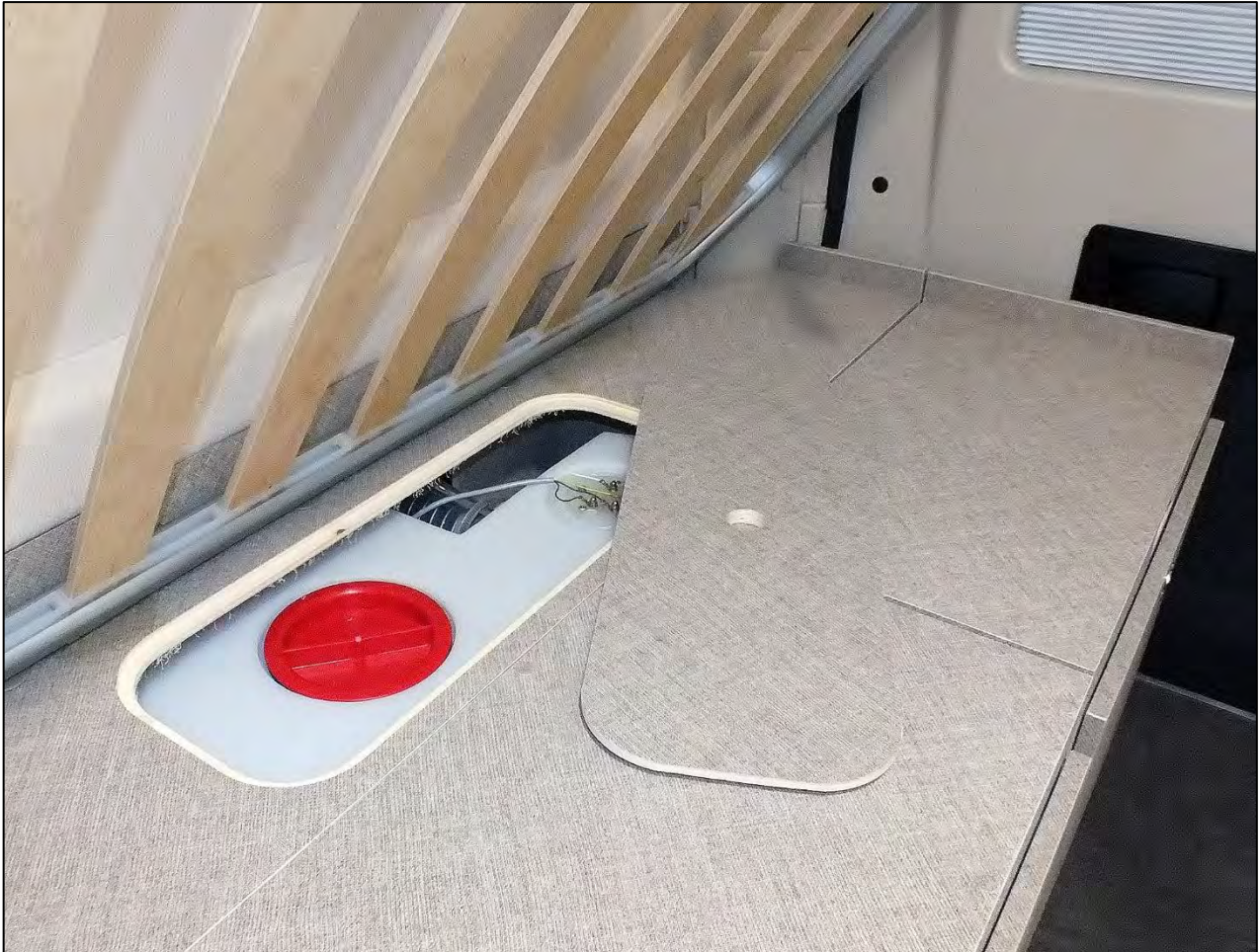
Zugang Frischwassertank (Abb. beispielhaft)
