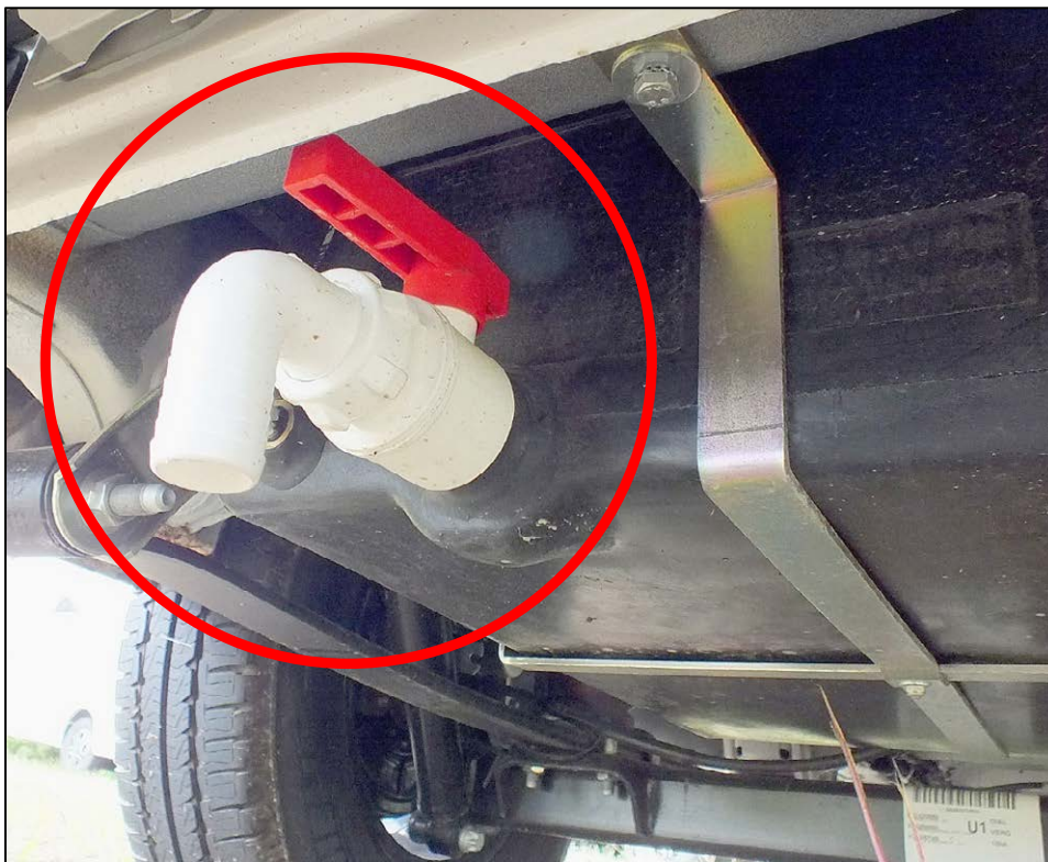
Drehverschluss zur Abwassertank Entleerung (Stellung geöffnet)
