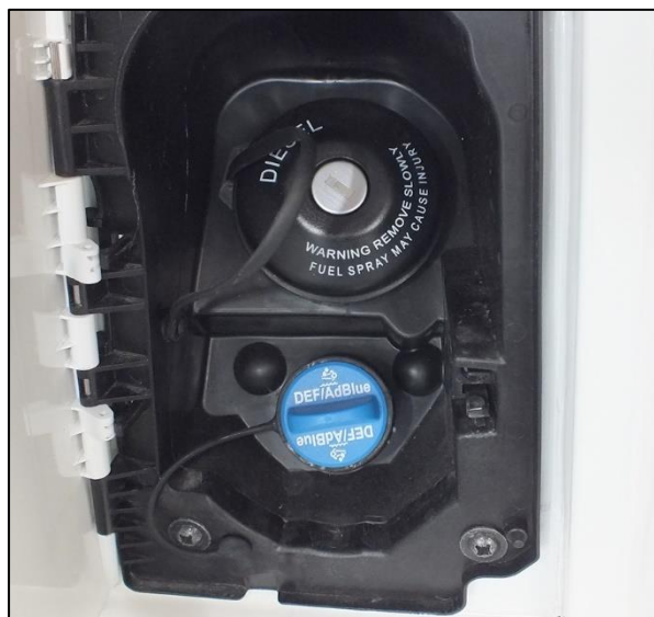
AdBlue Einfüllöffnung neben der Fahrertür (Abb. beispielhaft)
