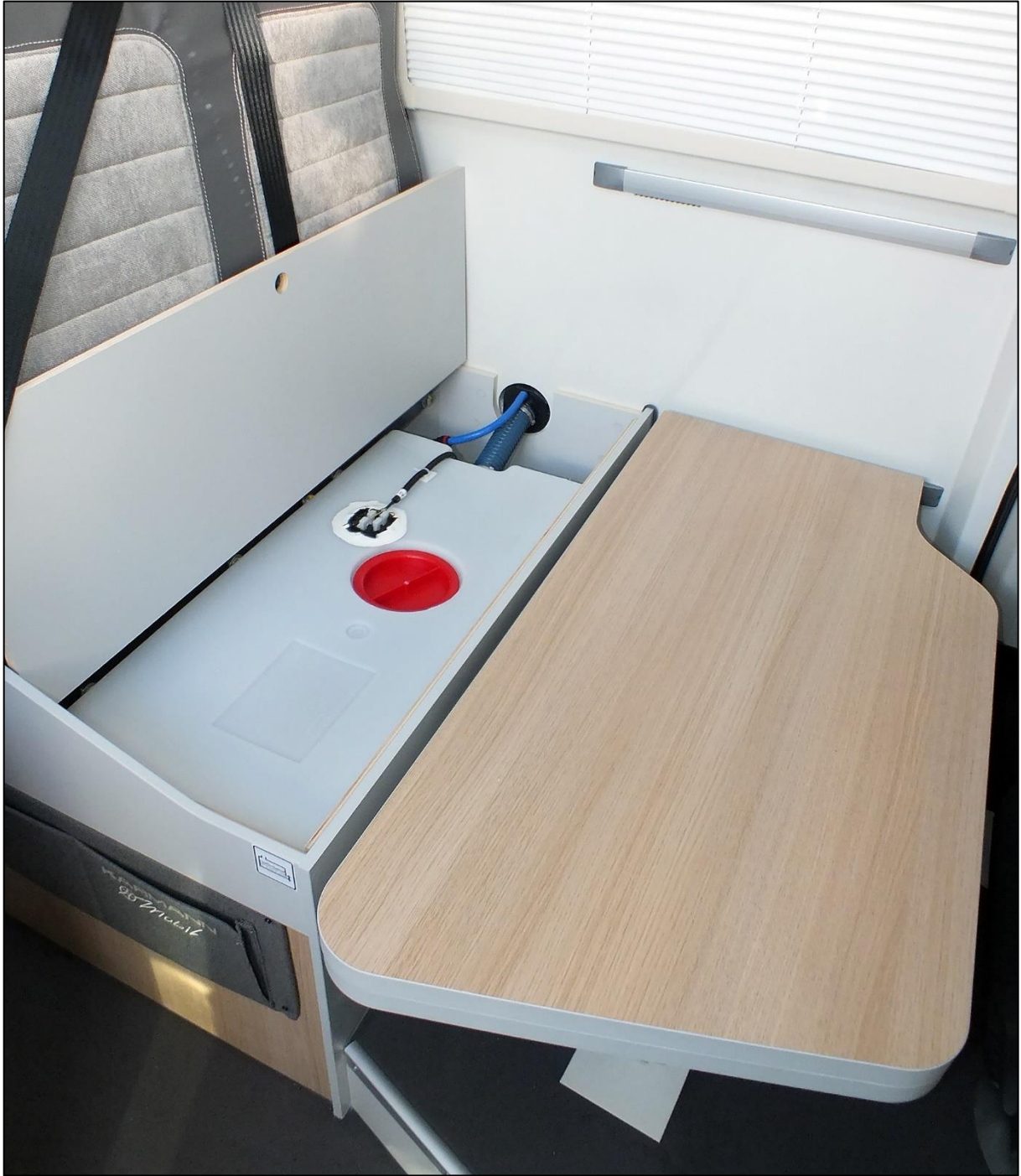
Depósito de agua limpia en la caja del asiento corrido (imagen de ejemplo)
