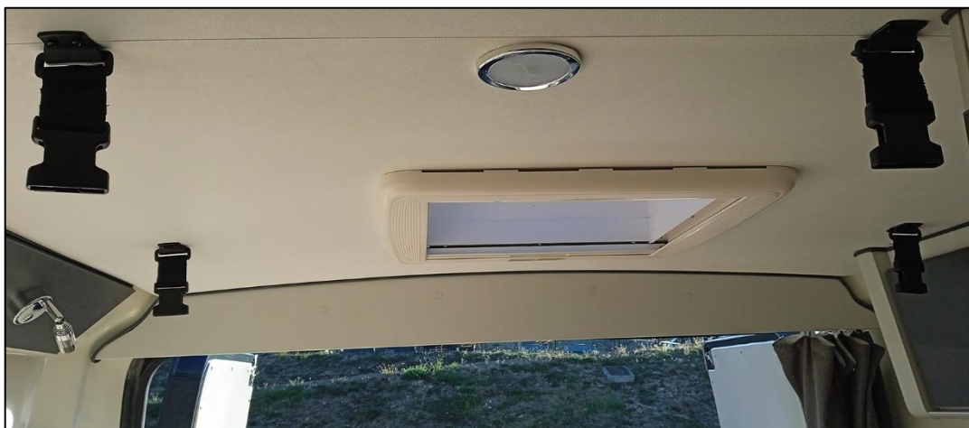
Gurtschließen an der Fahrzeugdecke zur Befestigung der Sicherungsnetzte des Etagenbetts (Abb. beispielhaft)
